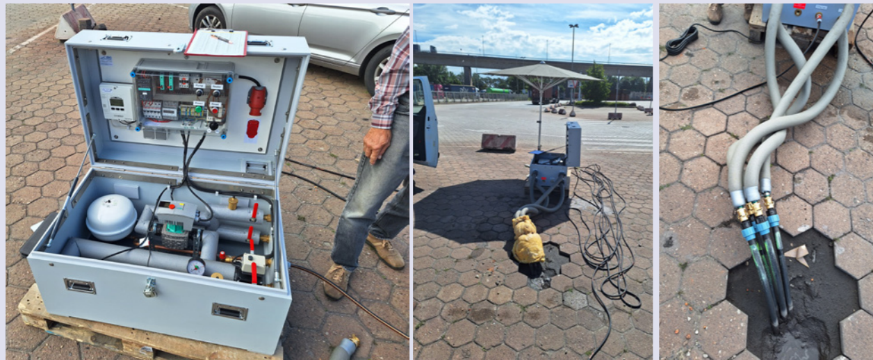
Messgerät für Geothermal Response Tests – auf Palette oder Anhänger fast überall einsetzbar.
