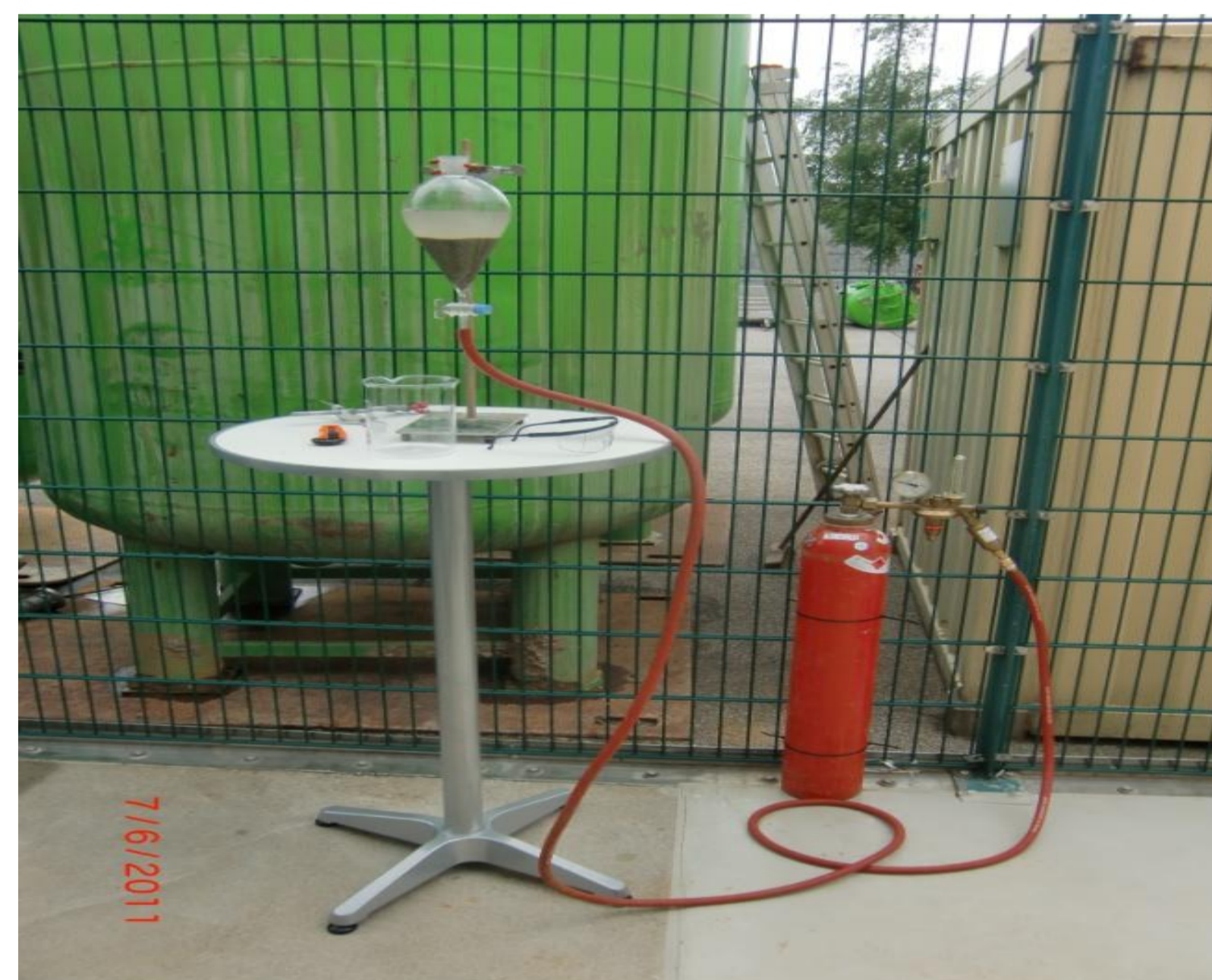
Abb. 1: Aufbau des Batchversuches mit Bio-Palladium und elementarem Wasserstoff
